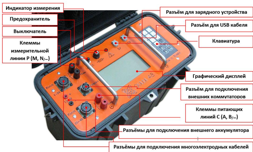
Рисунок 15 – Приборная панель, элементы управления и индикации, разъемы для подключения электроразведочных кабелей, проводов, зарядного и считывающего устройств
